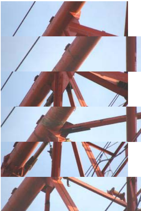
სურ.4.6. ამწის ხიდურაზე ზოგიერთი კვანძის ფოტოსურათი სადაც გამოვლენილი იქნა დაუშვებელი შენადული ნაკერები.
