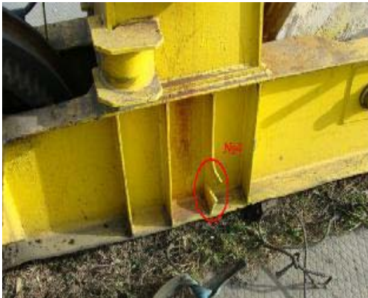
სურ.4.2. ულტრაბერითი მეთოდით შემოწმებული №2 და №3 პირაპირა ნაკერები.
