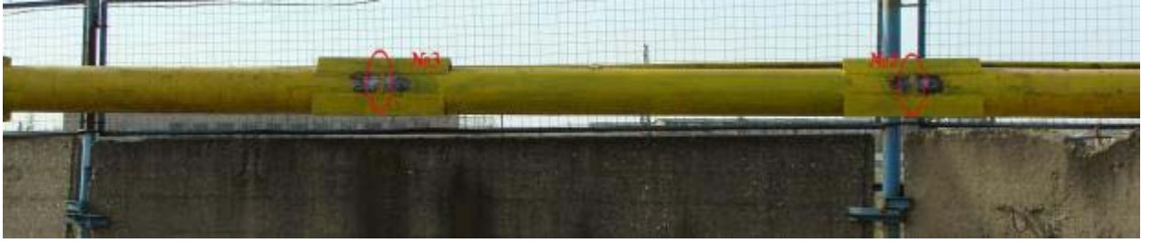
სურ.4.2. ულტრაბერითი მეთოდით შემოწმებული №2 და №3 პირაპირა ნაკერები.
