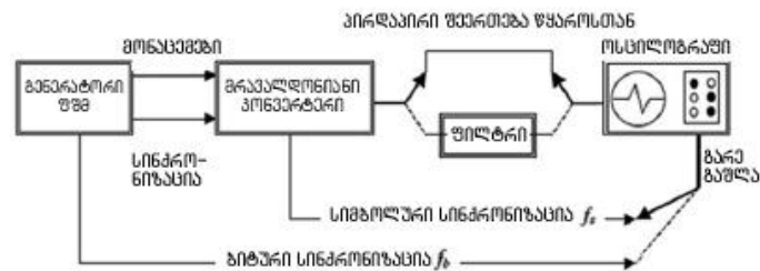
ნახ.4.16. თვალის დიაგრამის აგება: ფშმ - ფსევდომემთხვევითი მიმდევრობა
