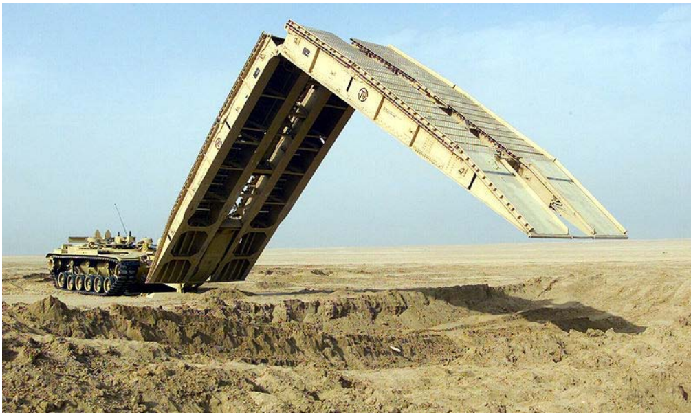
ფიგ. VI.8. – ცენტრალური კვანძის მიმართ ლიანდების ურთიერთშემობრუნებით განხორციელებული ტრანსფორმაციის პროცესი გაზრდილმალიან ხიდში და რეალურად არსებული კონსტრუქციული სისტემა ცენტრალური კვანძის მიმართ მბრუნავი ლიანდებისა.
