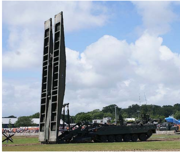
ფიგ. I. 17 – “Titan”-ის კლასის ერთმალისანი და ერთბლოკიანი ხიდის მონტაჟი, ხიდგამდებიდან მისი ”გადაბრუნებით”.
