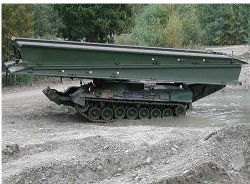
ფიგ. 1.7 – ა) ხიდგამდები, რომელიც ხიდს გადასალახ წინააღმდეგობაზე დებს “წამოცმის” მეთოდით სატრანსპორტო მდგომარეობაში; ბ) ხიდგამდები, ტელესკოპის ისრის გამოყენებით ამონტაჟებს “ტელესკოპის პრინციპით” ტრანსფორმირებად ხიდს.
