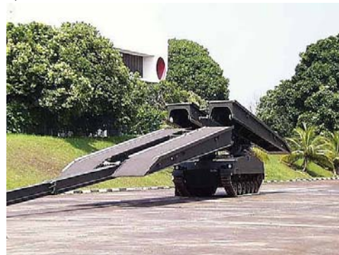
ფიგ. 1.7 – ა) ხიდგამდები, რომელიც ხიდს გადასალახ წინააღმდეგობაზე დებს “წამოცმის” მეთოდით სატრანსპორტო მდგომარეობაში; ბ) ხიდგამდები, ტელესკოპის ისრის გამოყენებით ამონტაჟებს “ტელესკოპის პრინციპით” ტრანსფორმირებად ხიდს.
