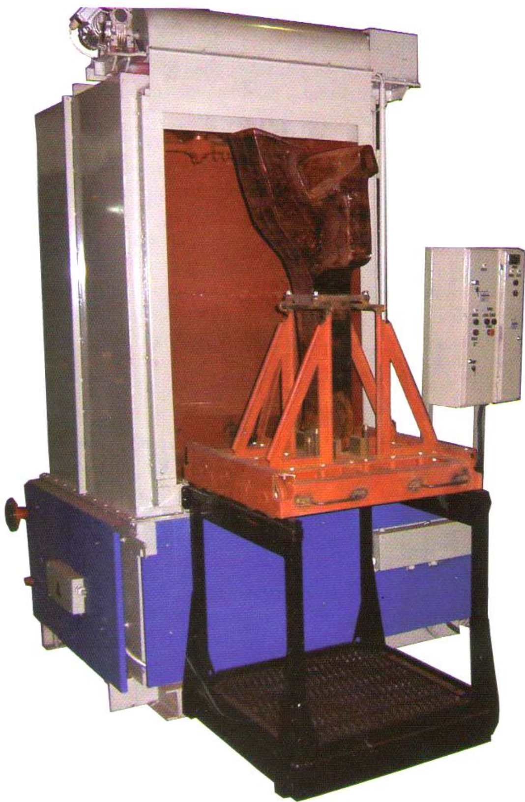
ნახ. 24. ავტოგადაბმულობის კორპუსის გამრეცხი ავტომატური მანქანა MKA 65
