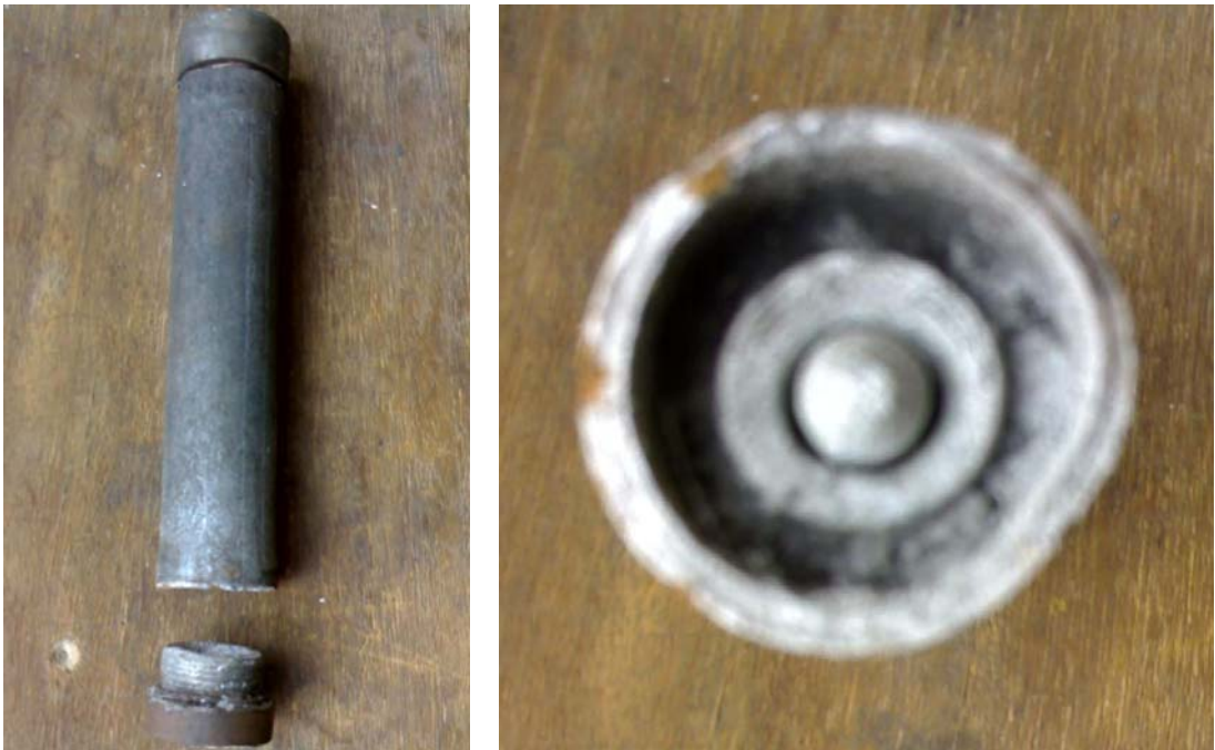
ნახ. 3.2.1.1. ნაყარი სიმკვრივის კაზმში აფეთქებით დატვირთვის დროს ანომალიური „კუმშვის“/გაფართოების შედეგი
