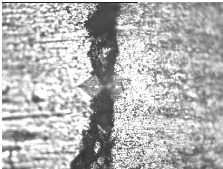
ნახ. 3.6.3. Fe- TiAlNi ფგმ-ის მიკროსტრუქტურა შეერთების ზონაში მიკროსისალის ანაბეჭდებით
