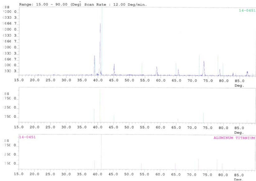
ნახ. 3.4.18. 50%Al- 50%Ti კაზმში 24 საათიანი დაფქვის დროს ფორმირებული ინტერმეტალიდი
