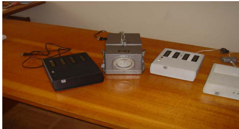
ნახ 2.4.2.1. ჩქაროსნული პროცესების ციფრული რეგისტრატორები
