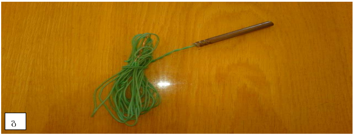
ნახ. 2.3.1 გამოყენებული ფეთქი მასალები: ა) ამონიტი №6 ბ) –სადეტონაციო ზონარი და ცეცხლგამტარი ზონარი; გ) დეტონატორი
