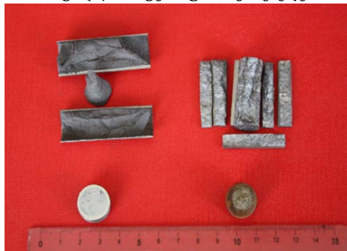
ნახ. 3.2.2.3. P=200კბარ წნევაზე და T= 20°C ტემპერატურაზე ტიტან-ალუმინ-ნიკელის კომპოზიციის კაზმის წნეხვის დროს მიღებული ნიმუშის სტრუქტურა. ცენტრალურ ზონაში მახის ტალღის მოქმედებით ადგილი აქვს ლოკალური რღვევის განვითარებას.
