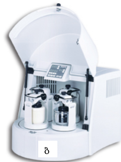
სურ. 2.2.2. ა) ლაბორატორიული შემრევი ნარევის ჰომოგენიზაციისთვის; ბ) „Retsch“-ის ფირმის პლანეტარული ნანოწისქვილი ცირკონიუმის ოქსიდის ჭიქებით და ბურთულებით.
