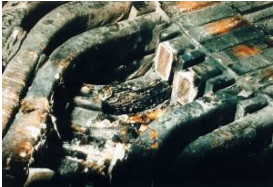
სურ. 3. დაზიანებული სტატორის გრაგნილის შუბლური ნაწილი.
