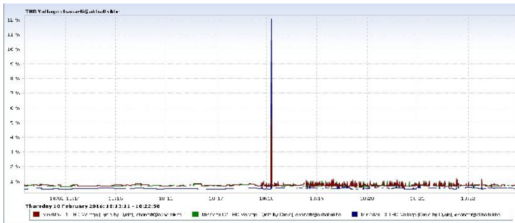
ნახ. 4.21. ძაბვის ჯამური დამახინჯების კოეფიციენტის ზოგადი სახე 10 საათი და 14 წუთიდან 22 წუთამდე მონაკვეთში.
