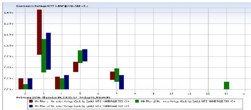
ნახ.4.13. 220 კვ სალტეებზე არასინუსოიდური ძაბვის სპექტრალური შემადგენლობა
