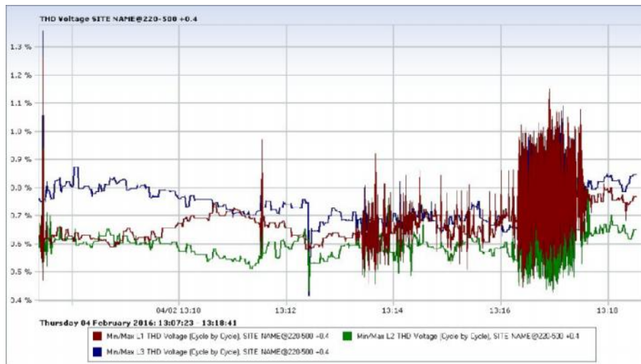
ნახ.4.10. 500კვ სალტეებზე ძაბვის ჯამური დამახინჯების კოეფიციენტის რეალური სახე:
