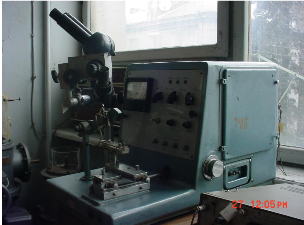
ნახ.5. კრისტალების ერთგვაროვნების შესამოწმებელი ელექტროგამტარობის ზონდური მეთოდის ხელსაწყო .
