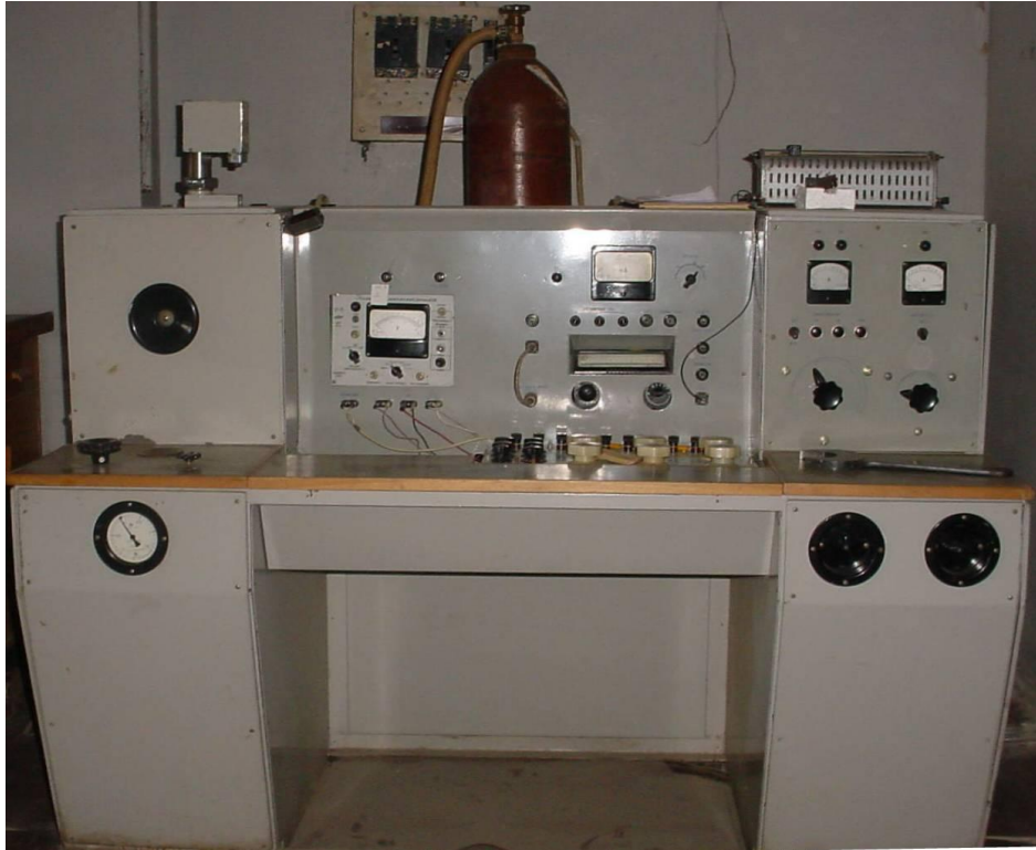
ნახ.10. ელექტრული თვისებების გასაზომი მოწყობილობა 78–300 K ტემპერატურის არეში.
