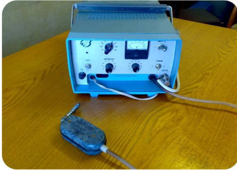
ნახ. 2.1. მოწყობილობა დეტალების ელექტრონაპერწკლური ლეგირებით აღდგენისათვის.
