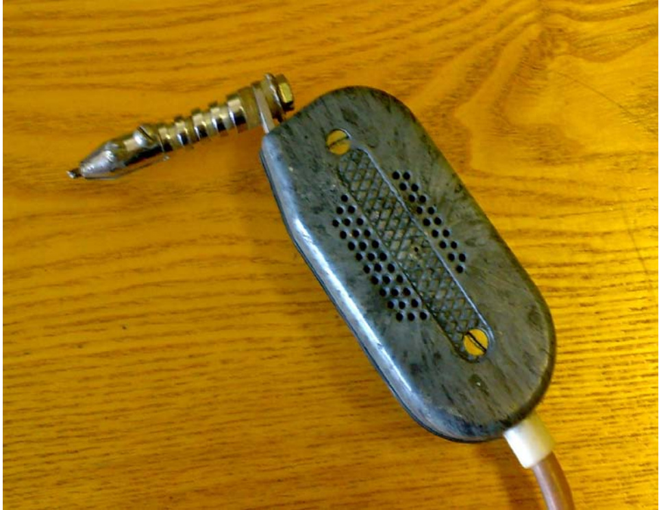
ნახ. 4.3. ელექტრონაპერწკლური ლეგირების ხელსაწყოს ელექტროდის დამჭერი.
