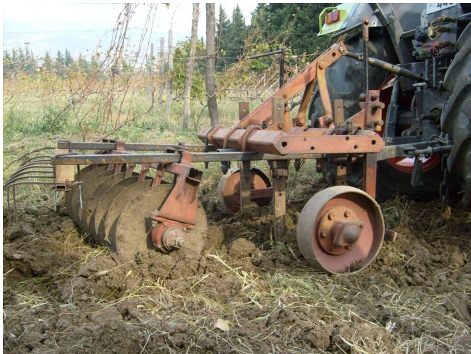
სურ. 4დ. ნიადაგდამამუშავებელი კომბინირებული მანქანის გვერდხედი
