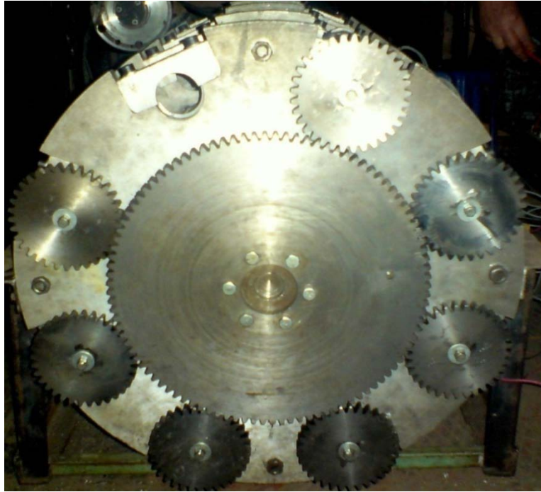
დანართი 4. მუდმივმაგნიტებიანი ძრავას ექსპერიმენტული ნიმუში (წინხედი)
