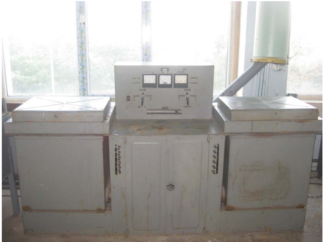
სურ. 2.1 დანადგარი ყვინთას გაცვეთილი ზედაპირის რკინა-ქრომის ელექტროლიტური საფარის აღდგენისათვის.
