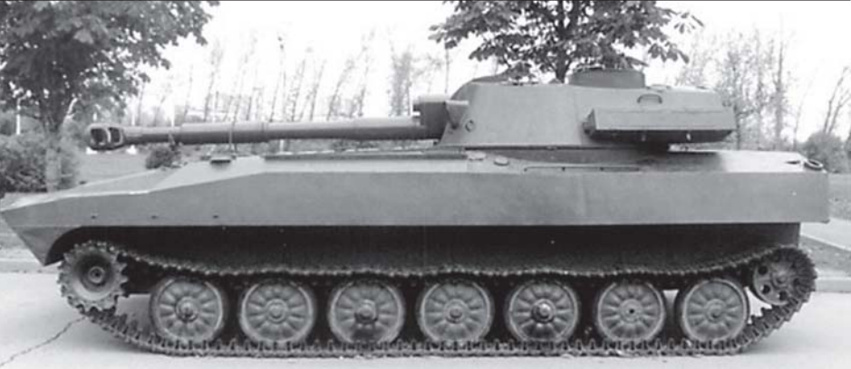
ჩვენი დოკი: 122 მმ კალიბრის თვითმავალი პაუბიკა 2С1Г воездика შექმნილია ჯავშნის გახმევის МТ-ЛБ-ს ბაზაზე. მისი საარტილერიო ნაწილი ფაქტობრივად, Д-30 ბუქსირებადი პაუბიკიდანაა აღებული. საბრძოლო მანქანა მთლიანად 15,7 ტ-ს იწონის და შეუძლია წყალში ცურვა. ГВОЗДИКА-ს ეკიპაჟი 4 კაცისგან შედგება და იგი წუთში 5-8 გასროლას ასწრებს. ჭურვების მარაგი 40 ერთეულია. 21,7 კგ-იანი მსწრევად-ფუგასურ ჭურვს ГВОЗДИКА მაქსიმალურ 15,3 კმ სიშორეზე ისვრის.
