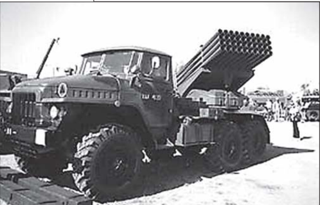
ჩვენი დოკი: 122 მმ კალიბრის ზალბური ცეცხლის რეაქტიული სისტემა БМ-21Град-ი „ურალის“ ტიპის მალალი გამავლობის ავტომობილზეა დამონტაჟებული, მისი მთლიანი საბრძოლო მასა 13,7 ტონაა. საბრძოლო კომპლექტის 40-ივე რაკეტის გასაშვებად სულ 20 წამია საკმარისი. Град-ის რაკეტის ფრენის მაქსიმალური სიშორე 20,5 კმ-ს აღწევს. თავად რაკეტის მასა 66 კგ-ზე მეტია, აქედან 19 კგ საბრძოლო ნაწილზე მოდის.
