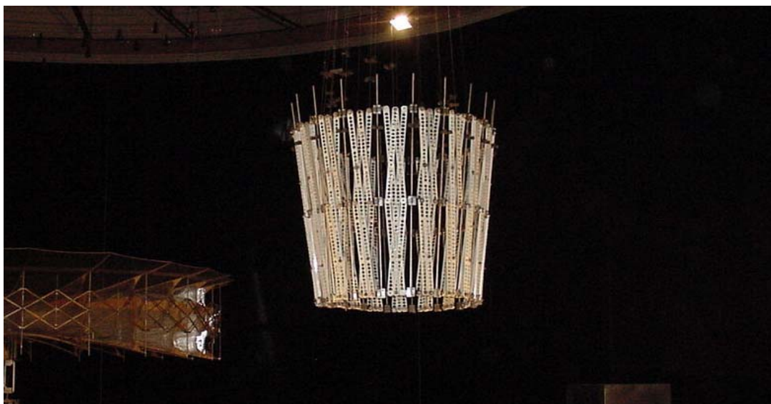
ფიგ. 5.3. “EVM-2” ძალოვანი რგოლის ექსპერიმენტული მოდელი დაკეცილ მდგომარეობაში.
