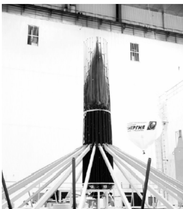
ფიგ. 3.6.3. თევზში დაკეცილ მდგომარეობაში ინტეგრირებული გაუწონადობის სისტემასთან.
