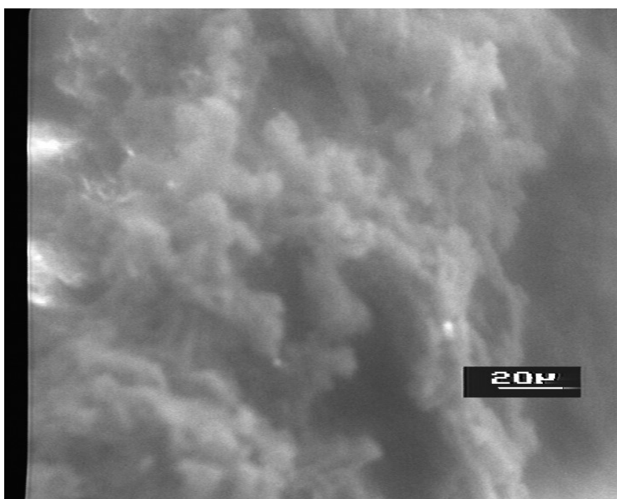
ნახ. 8 კრისტალური ცელულოზის (I) და იუგლონილიმობილიზირებული ცელულოზის (II) მიკროფოტოგრაფია
