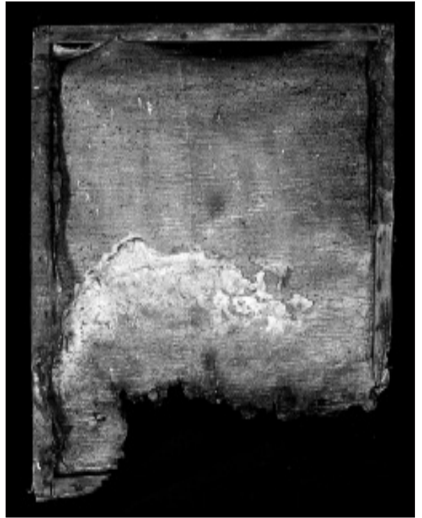
ტილოს უკანა ნაწილი, მიკრობიოლოგიური აქტივობა (სურ. 2)
