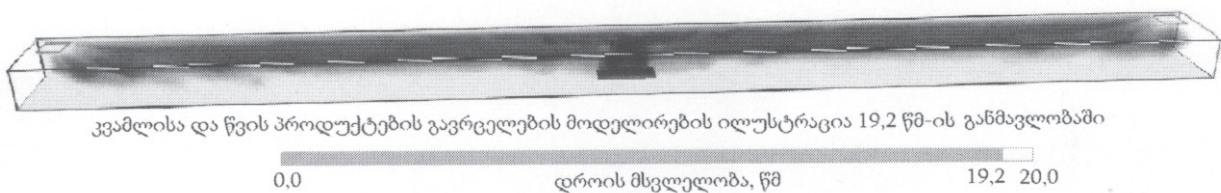
ნახ. 2. კვამლის გავრცელების სიჩქარის განსაზღვრისათვის: ხანძრის კერიდან პორტალებამდე მანძილი შეადგენს 50 მ; წნევათა სხვაობა პორტალებს შორის 200 პა
