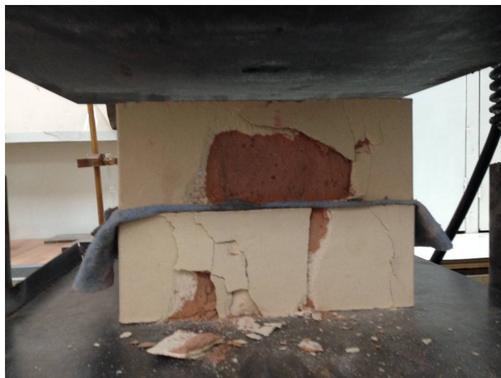
Рис.4. Лабораторные испытания прочности облицовочного кирпича.
