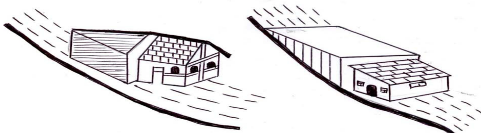
ნახ. 3. შესაბამისი კონსტრუქციებით საცხოვრებელი სახლების დაცვა ზვავებისაგან
