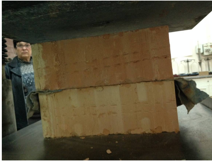
Рис.1. Лабораторные испытания прочности облицовочного кирпича. Обратная сторона испытуемых образцов кирпичной кладки при нагрузке 2,0 МПа
