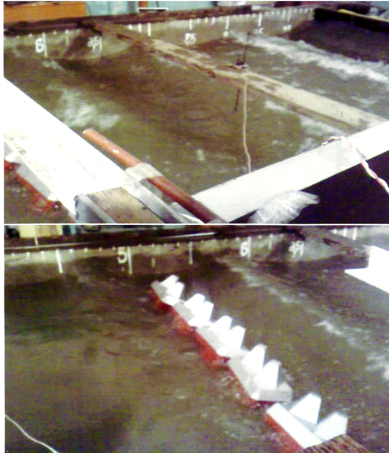
ნახ.4. პროექტში შემოთავაზებული ერთ-ერთი ტალღაჩამსშობი კონსტრუქციის ბმული კომპლექსის სისტემის წინასწარი ექსპერიმენტული კვლევა ტალღაგენერატორზე ივ. ჯავახიშვილის სახელობის თბილისის სახელმწიფო უნივერსიტეტის ოკეანოლოგიისა და მექანიკის ლაბორატორიაში
