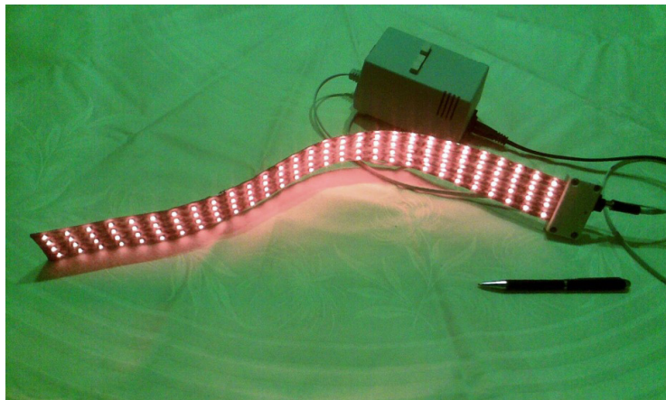
სურათი 8. “ლაზერი” მოქნილი გამომსხივებლით, დამწვრობისა და პლასტიკური ქირურგიის ცენტრისთვის.
