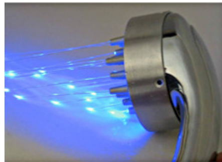
სურათი 10. ოპტიკური შხაპი, სადაც სინათლის ჭავლის ჰიდროდინამიკურ წნევასა და ტემპერატურასთან ერთად ადამიანზე მოქმედებს ოპტიკური გამოსხივებაც.
