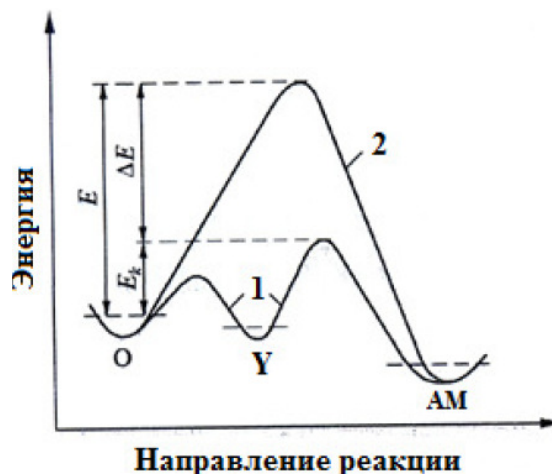
Рисунок 9. Энергия активации реагирующей системы кислород – анодируемый материал с использованием Y (1) и без него (2).
