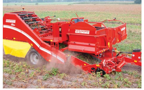
კარტოფილის ამღები ბუნკერიანი ან ელევატორიანი მისაზგებელი კომბინი
