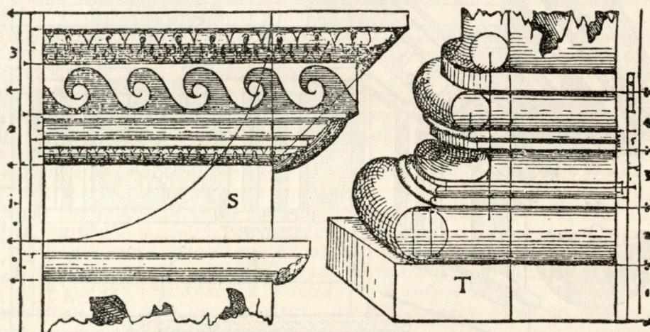
валика над нижним валом делаются таким образом: каждый из них занимает половину одной части, а полочка над ними составляет половину толщины валика. Валик под верхним валом делается таким образом: в толщину он делится на пять частей, из них три приходятся на валик и две — на полочку. Выступ облома должен равняться четверти толщины колонны. Все члены его должны иметь выступ, как это показано на рисунке.
