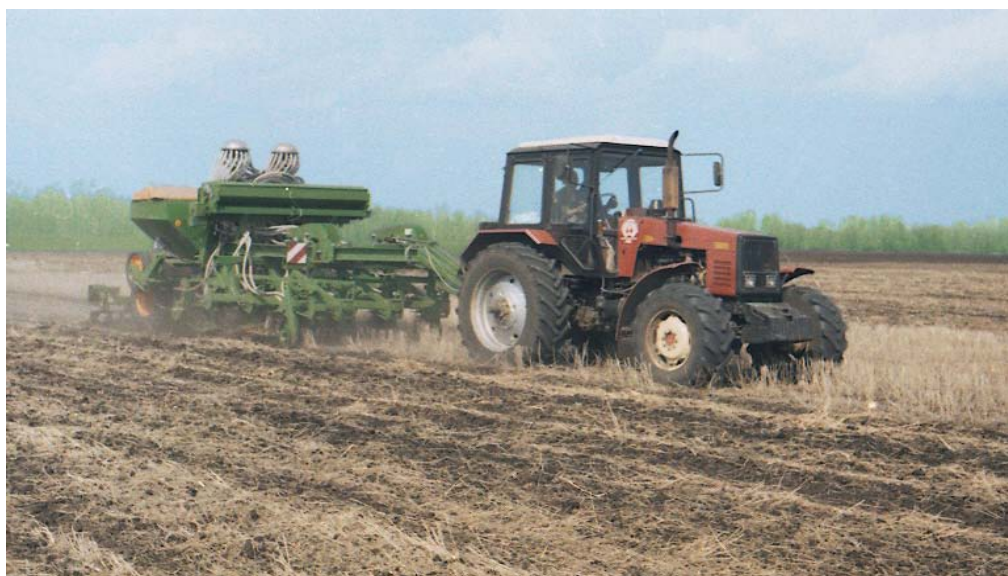
სურ. 1.4. ნაწვერაღზე პირდაპირი თესვა (ნულოვანი დამუშავების ტექნოლოგია)
