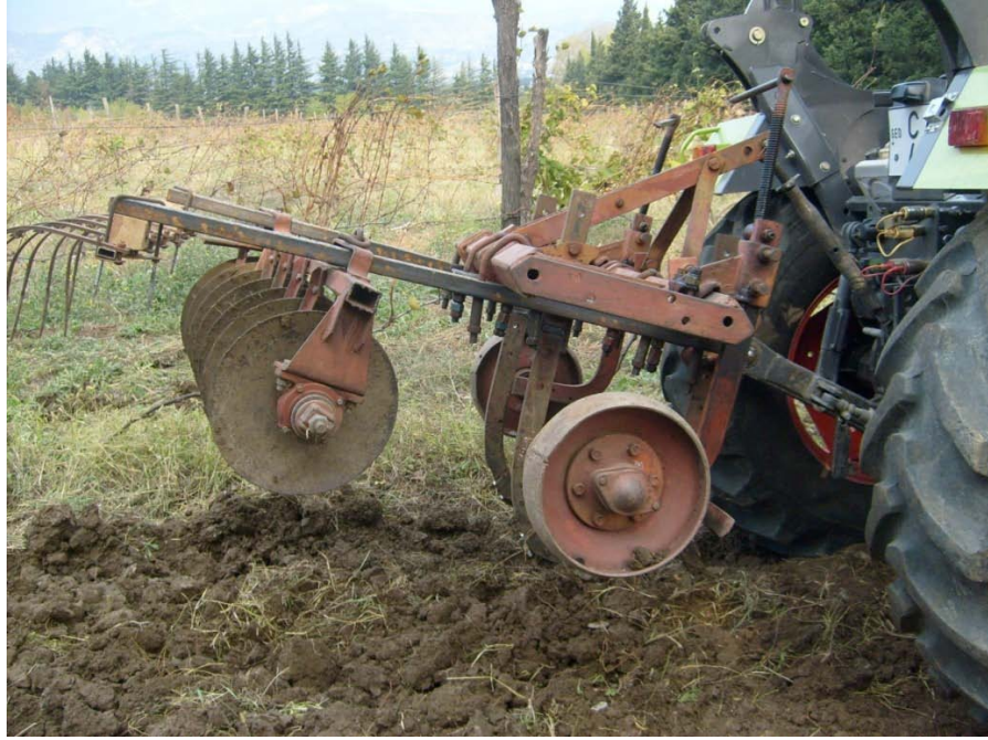
სურ. 1დ. ნიადაგდამამუშავებელი კომბინირებული მანქანა სატრანსპორტო მდგომარეობაში
