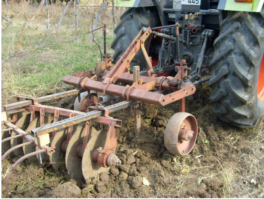
სურ. 3დ. ნიადაგდამამუშავებელი კომბინირებული მანქანის უკანა ხედი
