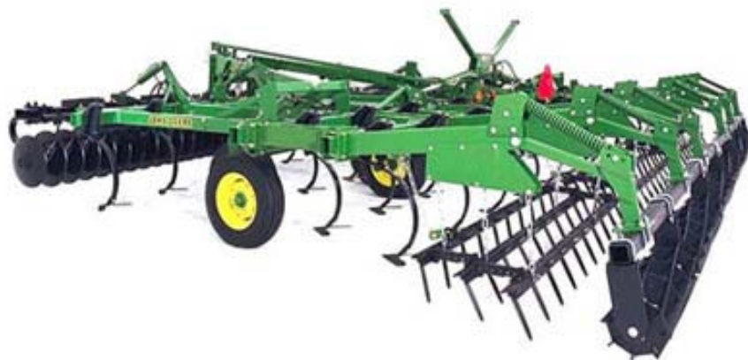
სურ. 2.2. ნაწვერალის დასამუშავებელი კომბინირებული კულტივატორი John Deere 726 (აშშ)
