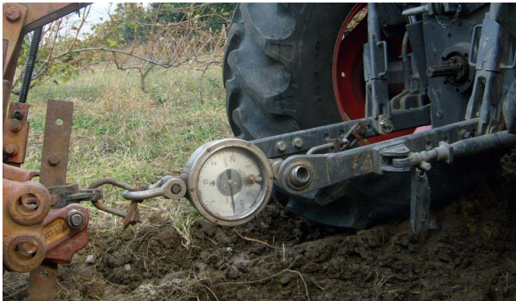
სურ. 5დ. ნიადაგდამამუშავებელი კომბინირებული მანქანა ექსპერიმენტული კვლევის დროს
