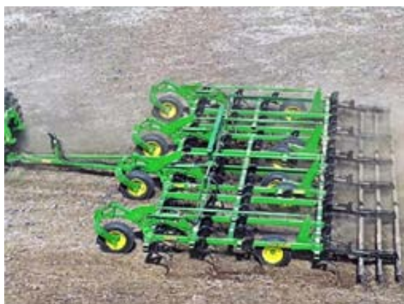
სურ. 2.3. მთლიანი დამუშავების კულტივატორი John Deere 2210 (აშშ)
