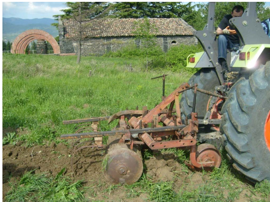
სურ. 2დ. ნიადაგდამამუშავებელი კომბინირებული მანქანა მუშაობის დროს
