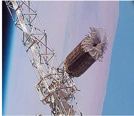
კოსმოსური ობიექტი მიმაგრებულია კონსტრუქცია “სოფორა“-ზე და იგი მზად არის გასაშლელად.
