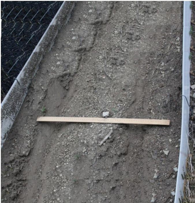
სურ. 6. საკვლევი ინტეგრირებული პოლიგონის საკონტროლო უბანზე ფორმირებული ნაღვარევის სიგანების (h, B) დადგენა
