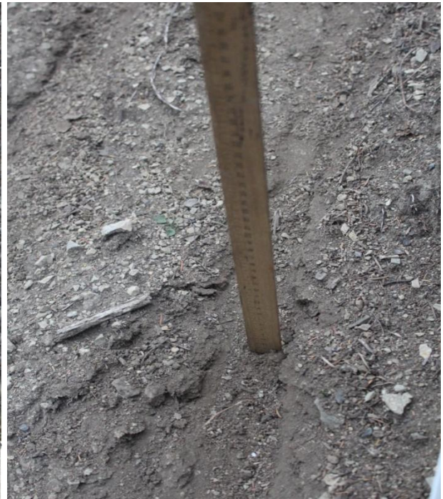
სურ. 7. საკვლევი ინტეგრირებული პოლიგონის საკონტროლო უბანზე ნაღვარევის სიღრმის დადგენა
