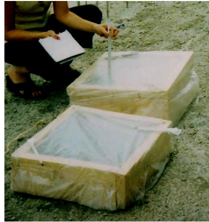
ფოტო 2. დაკვირვებები ბეტონის ტემპერატურულ დინამიკაზე ბეტონის საცდელ კუბიკებზე მოწყობილ მარტივ ჰელიომოწყობილობებში
