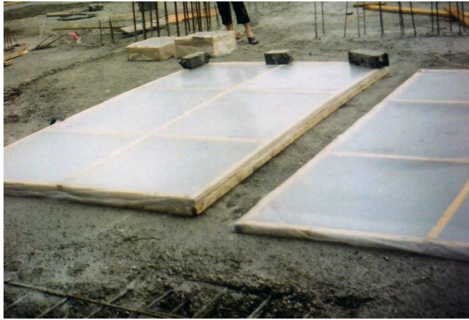
ფოტო 1. მარტივი ჰელიომოწყობილობა, რომლის შემომზადუდაც მასალას წარმოადგენდა გამჭვირვალე აფსკი
