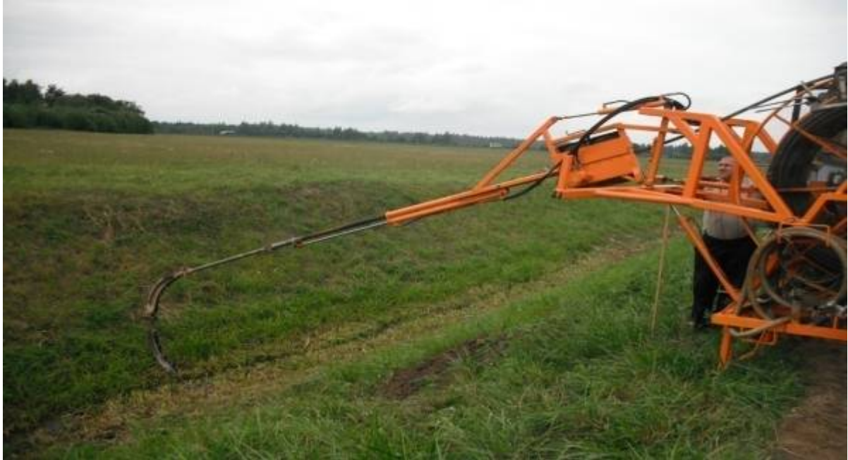
Рис. 4. Промывка дренажных коллекторов установкой УПД-120 с применением направляющего устройства конструкции ОАО "Пинский завод средств малой механизации"
