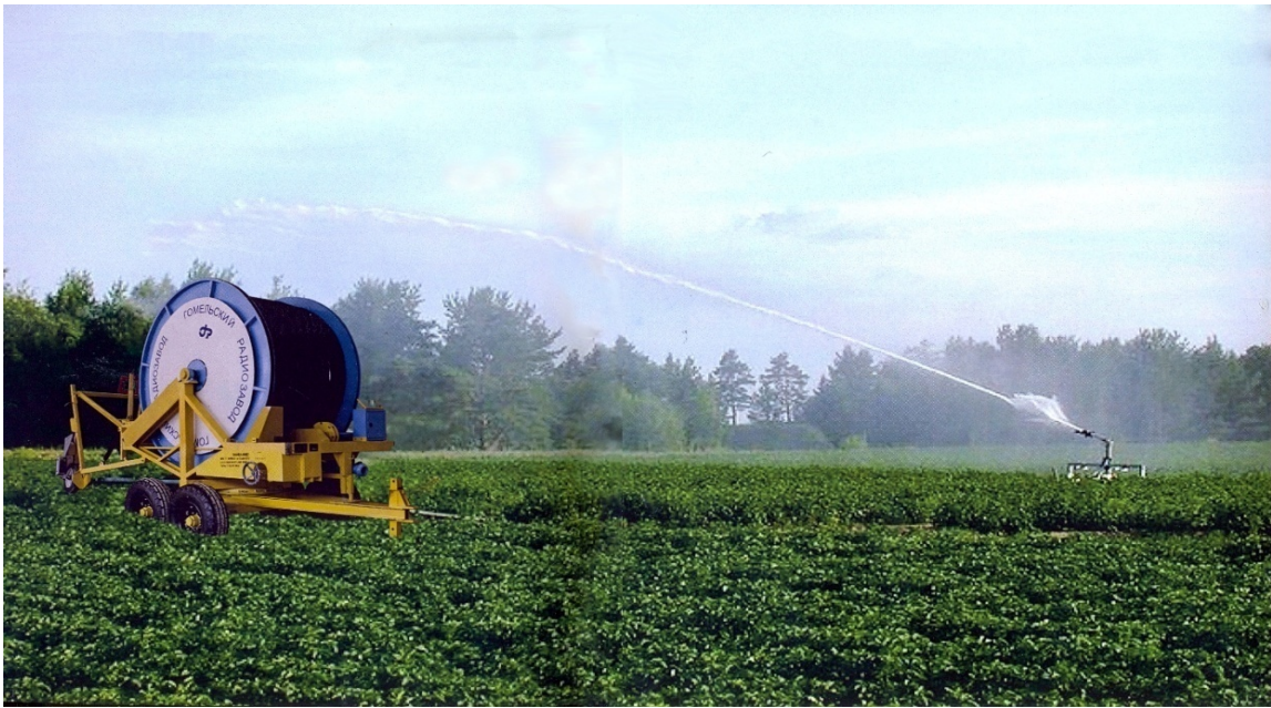
Фото 1. Барабанно-шланговая дождевальная машина ПДМ-2500 в работе.
