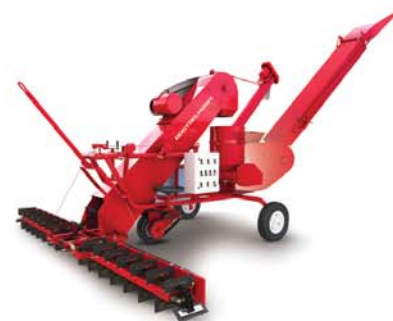
მარცვლეულის გადასამუშავებელი კომპლექსი 3MP-PCM-90 გადატვირთვა – 90 ტ/სთ. შენამვლა – 20 ტ/სთ.
