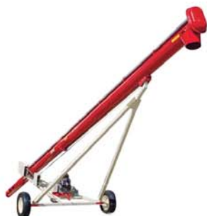
მარცვლეულის გადასატვირთი TMB-70/140/280 ჩატვირთვის მაქს. სიმაღლე – 12,8 მ-მდე წარმადობა – 70-დან 280 ტ-მდე/სთ.
