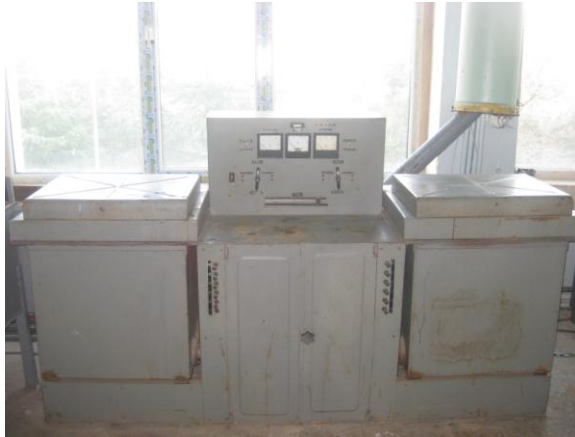
სურ. 2.1 დანადგარი ყვინთას გაცვეთილი ზედაპირის რეინაქრომის ელექტროლიტური საფარის აღდგენისათვის.
