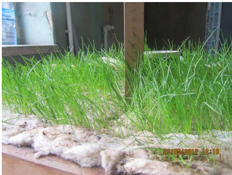
სურ. 3 გეოხალიჩა “ნესგეო“-ზე ამოსული მცენარე კონდარის ამონაყარის სიმაღლე 8-10 სმ, (23.05.2012)
